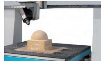
El recorrido del Eje Z puede alzarse hasta 750 mm, por lo que será muy adecuado para procesados de superficies a gran escala y especialmente indicada para el procesado de superficies 3D curvadas.
