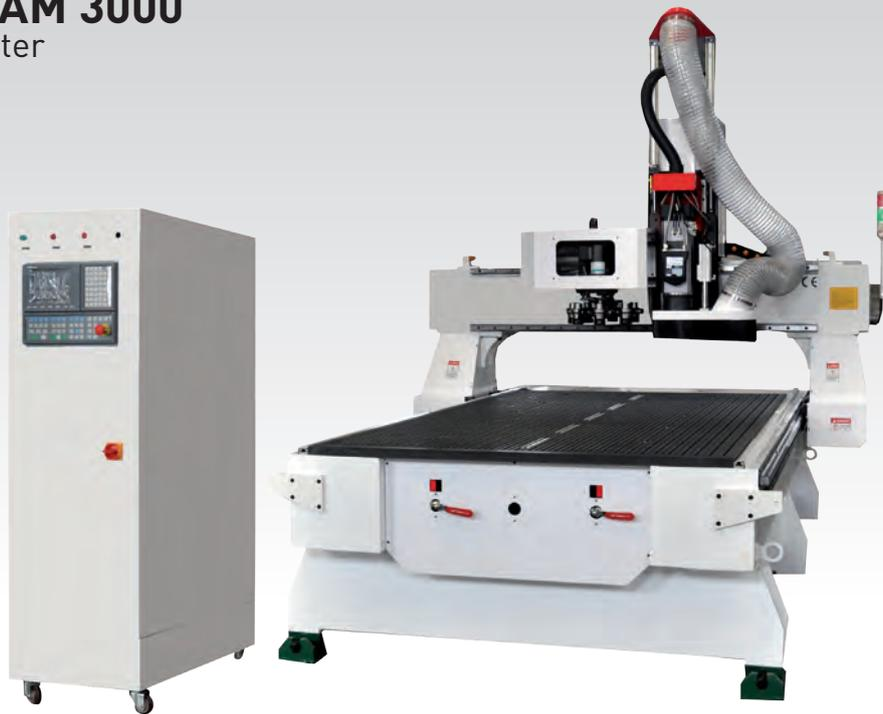
El sistema de fresado TEC-CAM 3000 se basa en una estructura del tipo tubular/viga de acero. Las vigas que componen esta estructura son sometidas a un proceso de soldado y desestresado garantizando así la homogeneidad del conjunto. Cada pieza se une y adapta a la otra formando un único bloque rígido y estable.
