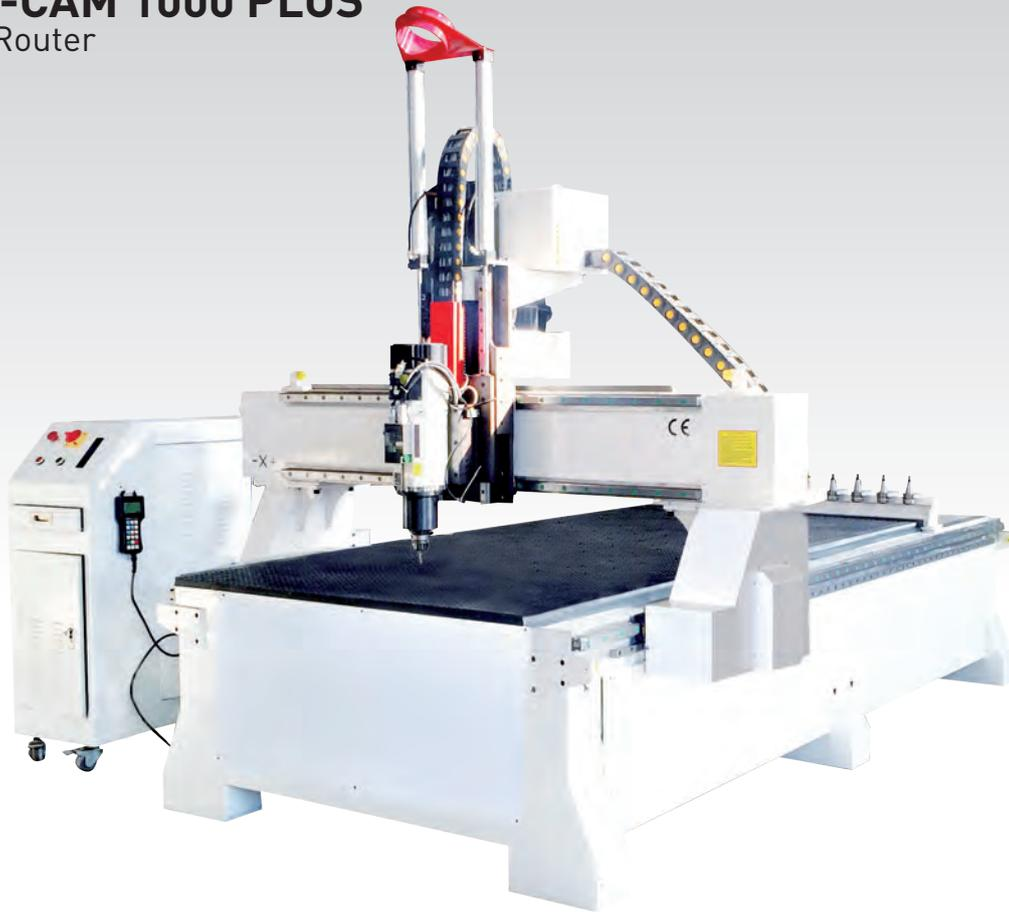
El sistema CNC TEC-CAM 1000 Plus, lleva incorporado un ATC lineal para un cambio rápido y automático de herramienta, optimizando tiempos de programación.
