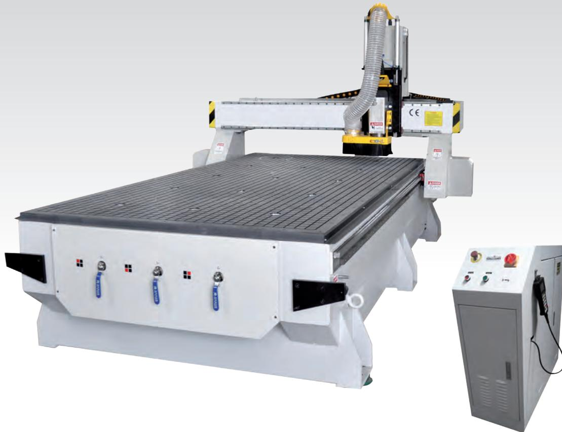
El sistema CNC TEC-CAM Serie 1000 combina componentes de alta calidad. Se pueden trabajar materiales, tanto corte como grabado de: metacrilato, PVC, DM, madera maciza, aluminio, cobre, latón, porexpan, foam y muchos más.
