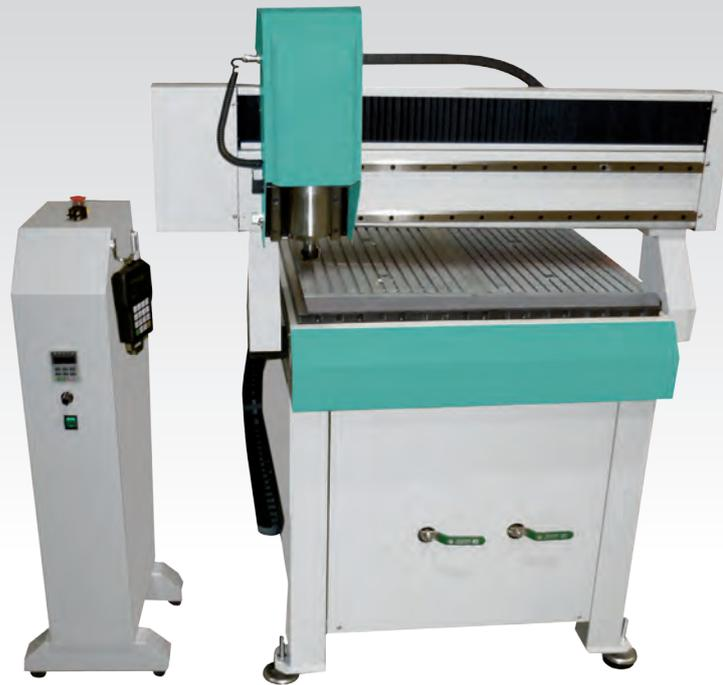
Indicada para el proceso y la fabricación de múltiples aplicaciones como señalización, rótulos, medallas, maquetas, paneles eléctricos, etc. Puede trabajar con materiales metálicos y no metálicos como por ejemplo: aluminio, cobre, plástico y madera.
