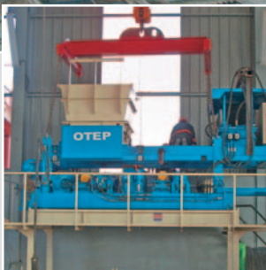
POUTRELLES DE PLANCHERS. Procédé par filage.
