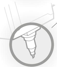
**3. Cabezal de Marcado**, para lograr diferentes profundidades y velocidades de marcado.
