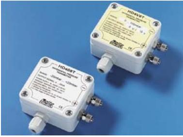
Los modelos HD 408T y HD 4v8T son transmisores de presión relativa o diferencial con respecto a la atmósfera con salida analógica, se pueden utilizar en todas aquellas aplicaciones donde hay que monitorear aire o un gas no corrosivo con campos de presión entre 10 mbar y 2000 mbar. El sensor piezo-resistivo proporciona medidas muy precisas y estables de la presión diferencial aplicada, con repetibilidad excelente, histéresis baja y un comportamiento óptimo en temperatura.
