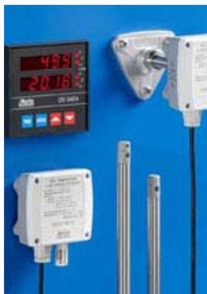
Los transmisores serie HD37BT... y HD37VBT... se emplean principalmente en el control de la calidad del aire mediante la medición del CO<sub>2</sub> (bióxido de carbono) en las instalaciones de ventilación. Esto permite variar el número de sustituciones / hora del aire, según las normativas ASHRAE y IMC. Las salidas analógicas, pueden ser en corriente 4...20mA o en tensión 0...10Vcc
