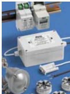
El HD 778 TCAL es un generador de tensión con un rango entre -60 mV y 60 mV que, controlado por un PC a través de la puerta serial RS232C, con el software DELTALOG 7 suministrado con el instrumento, puede utilizarse para la configuración de transmisores para termopares tipos K (Níquel-Cromo/Níquel-Alumel), J (Hierro/Cobre-Níquel), T (Cobre/Cobre-Níquel) y N (Níquel-Cromo-Silicio/Níquel-Silicio)
