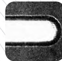
DURALLOY® TDC Schichtdicke: 2,5 µm
