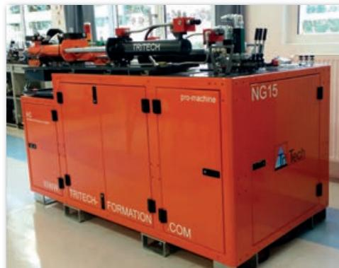
La variation de vitesse du moteur électrique élargit le champ d'application du **nouveau banc de simulation**. La pompe à cylindrée fixe délivre un débit variable et peut travailler en boucle fermée.
