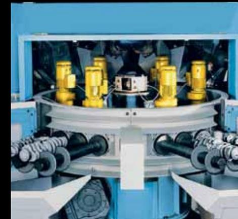
Shot peening totalmente automatizado de más de 600 cigüeñales/hora en máquina DS
