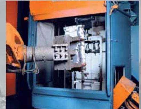
Máquina de granallado de carga suspendida en ciclo
