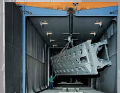
Cámara de granallado para bloque motor diesel de 80 toneladas
