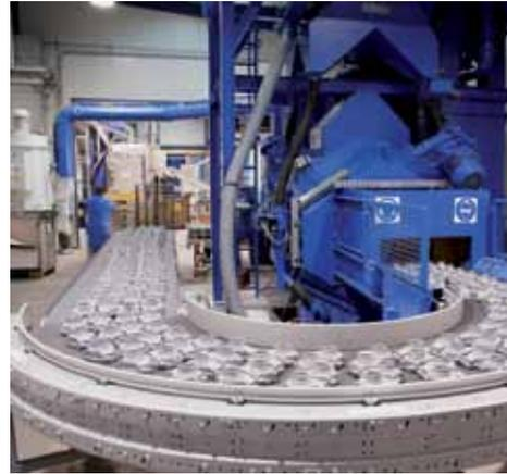
Granalladora de malla metálica
