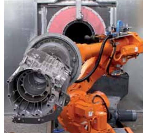
Célula de acabado con garra robótica
