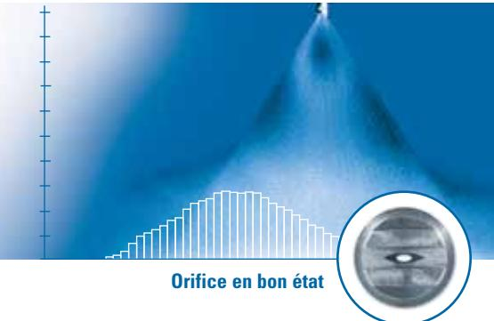
Une inspection visuelle de l'orifice de la buse et de la pulvérisation révèle peu de signes d'usure. Une analyse des données de pulvérisation enregistrées révèle une augmentation du débit de 30% de l'orifice usé.
