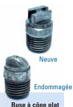
application à l'autre - parfois, il s'agit d'usure dans un processus à haute pression, ou il s'agit d'encrassement si vous vaporisez un liquide visqueux. La performance de la buse peut être réduite ou totalement inefficace si les orifices des buses sont érodés, endommagés ou obstrués.
