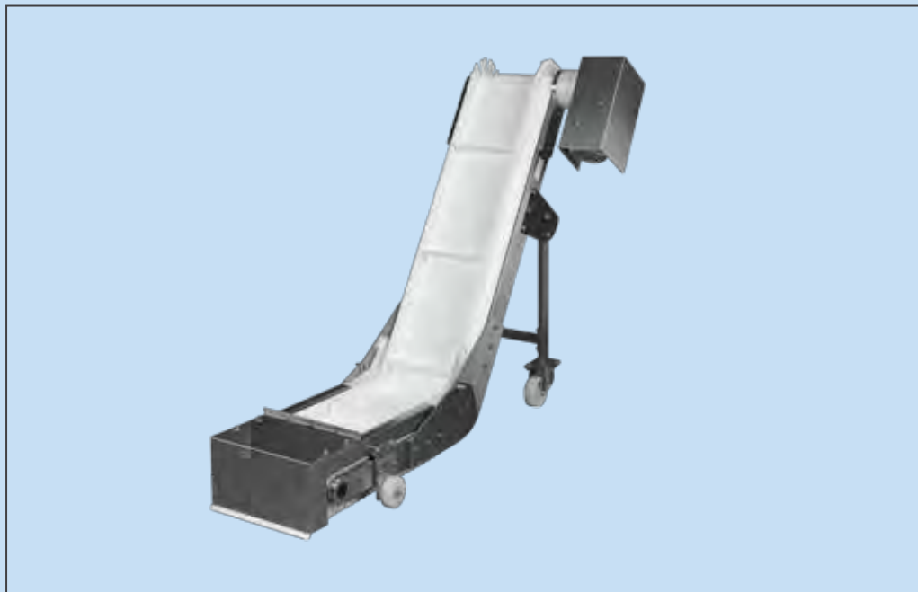
— Robustes Knickförderband mit Stollenkette aus Kunststoff-Gliedern, Trichter und Rückfallklappe an der Aufgabestelle.
