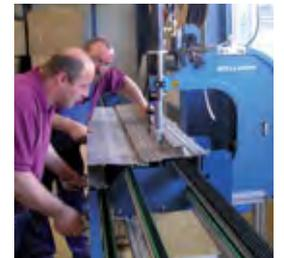
Utilización de equipos manuales para la colocación de remaches auto perforadores para el montaje de una puerta. En la foto más grande se puede ver una máquina manual con dispositivo giroscópico.
