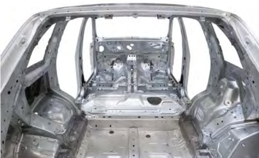
Tecnología de remachado auto perforador de Böllhoff para la fabricación de la moderna carrocería del Audi Q7 con un equipo guiado por un robot en la fábrica de Volkswagen en Bratislava.
