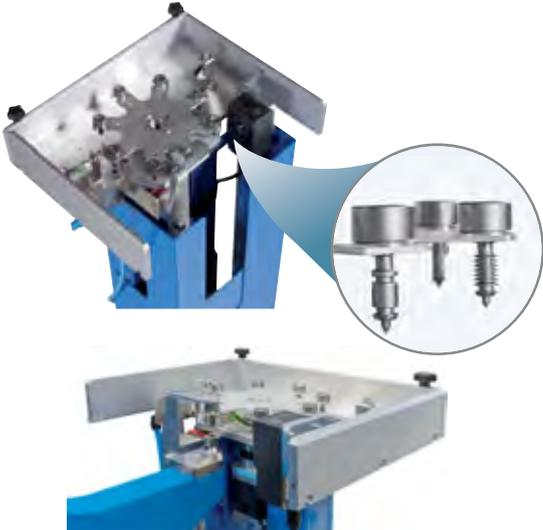
**Para la fabricación de prototipos, producción en serie o a pequeña escala y gestión de piezas de recambio – Cambiadores de matrices RIVSET®**
