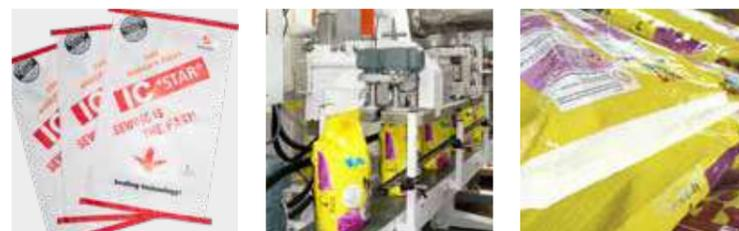
Le système de fermeture de sacs breveté "Over Tape Bag Sealer" de STATEC BINDER soude hermétiquement les sacs en polypropylène (PP) tissé. Un ruban de tissu PP est utilisé pour assurer une fermeture fiable et sûre. Au besoin, les sacs peuvent également être cousus. Les sacs d'oreiller et les sacs à gousset peuvent être fermés. Cette technique de soudage facilite la manipulation des produits poussiéreux et très odorants de l'industrie agroalimentaire et des aliments pour animaux.
