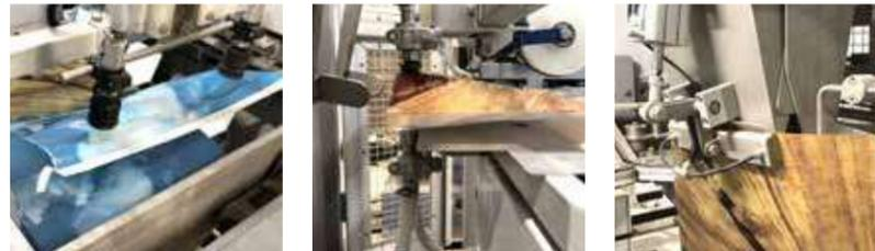
L'ACROPAC est une ensacheuse entièrement automatique capable d'atteindre une cadence de 600 sacs par heure. Cette machine s'adresse par conséquent à tous ceux qui veulent remplacer leur système d'ensachage manuel/semi-automatique par une solution d'ensachage entièrement automatique et/ou de faible capacité. Que ce soit des granulés de matières plastiques, des aliments pour animaux, des engrais chimiques ou des aliments, l'ACROPAC convient à l'ensachage de produits en vrac.
