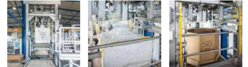
La BIG BAG Station de remplissage semi-automatique assure le remplissage de Big Bags (FIBC) avec un, deux ou quatre boucles et d'octabines pour un poids de remplissage compris entre 500 et 1.500 kg.
