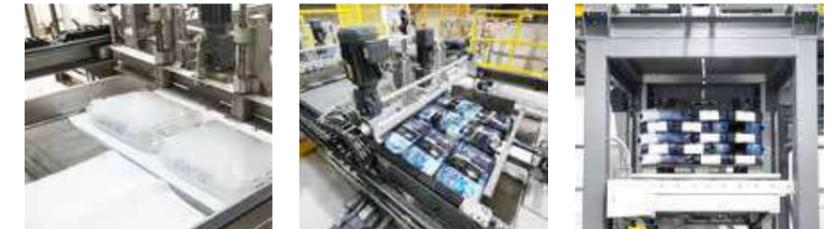
Le robot de palettisation haute performance PRINCIPAL-R, un robot de palettisation à bras articulé, est toujours proposé comme une solution sur mesure issue du savoir-faire de STATEC BINDER et des fabricants de robots industriels établis. Selon les performances recherchées, il existe différents modèles de robot. Le grappin est aussi adapté à l'application. Le système PRINCIPAL-R a un atout: il a été optimisé pour les sacs en bandoulière.
