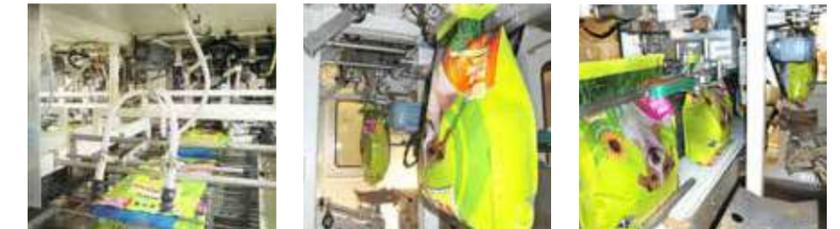
La version Twin de l'ensacheuse de sacs ouverts réunit en une seule machine deux positionneurs de sacs et deux stations de remplissage. Deux peseuses nettes STATEC BINDER haute performance veillent au dosage et au pesage précis du produit. Une fois le poids requis atteint, la trémie de pesage s'ouvre et le produit s'écoule dans le sac attaché au niveau du bec verseur. Une machine de fermeture des sacs hautes performances assure la couture, le scellage ou le collage des sacs en toute rapidité.
