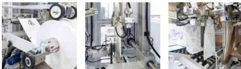
L'ensacheuse SYSTEM-T FFS entièrement automatique allie la qualité supérieure de l'emballage dans un sac PE tubulaire à une capacité de production élevée. Ces caractéristiques la rendent idéale dans de nombreux secteurs comme la pétrochimie, les engrais, les aliments pour animaux et l'agroalimentaire.
