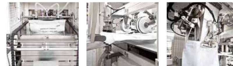
L'ensacheuse haute performance entièrement automatique CERTOPAC emballe les produits en vrac dans les sacs d'oreiller et les sacs à gousset dont le poids de remplissage est compris entre 5 kg et 80 kg. Cette machine à grande vitesse permet de remplir jusqu'à 1.500 sacs à l'heure.
