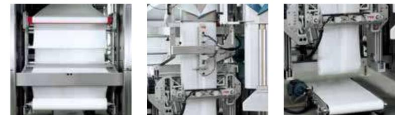
SYSTEM-F, une ensacheuse FFS verticale entièrement automatique, conçoit des sacs plats et des sacs à pli latéral à partir de film plat. Les sacs peuvent être fabriqués avec ou sans poignée de transport et pour un poids de remplissage compris entre 5 kg et 50 kg. La solution System-F convient tout particulièrement à l'emballage de produits en poudre et de produits à circulation modérément fluide.
