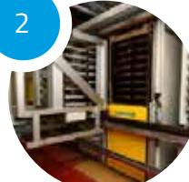
Atelier de stratification avec 5 presses et un atelier spécifique pour le pressage des flex-rigides installés dans une salle blanche (classe 10K), une base à vide et une machine ITC pour le bouchage des via.
