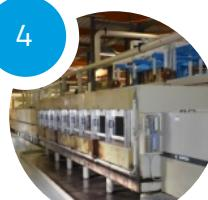
Préparation des trous avant métallisation avec plasma pour les matériaux exotiques et métallisation cuivre chimique et processus palladium.
