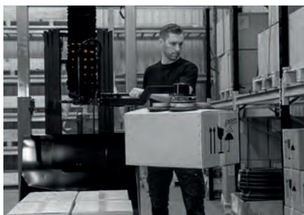
I sollevatori a vuoto mobili permettono la preparazione delle commesse ed una movimentazione dei materiali rapida ed efficiente. Ideali per operazioni di prelievo ordini ad alta velocità e di sollevamento in magazzino.
