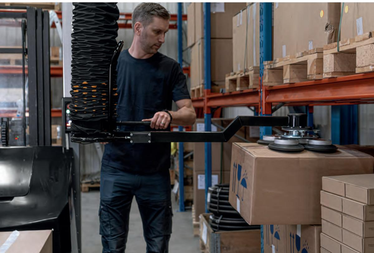
Grazie alla forma del telaio di presa Easy Reach, l'operatore può comodamente prelevare colli anche se posti al di sotto di ingombri.
