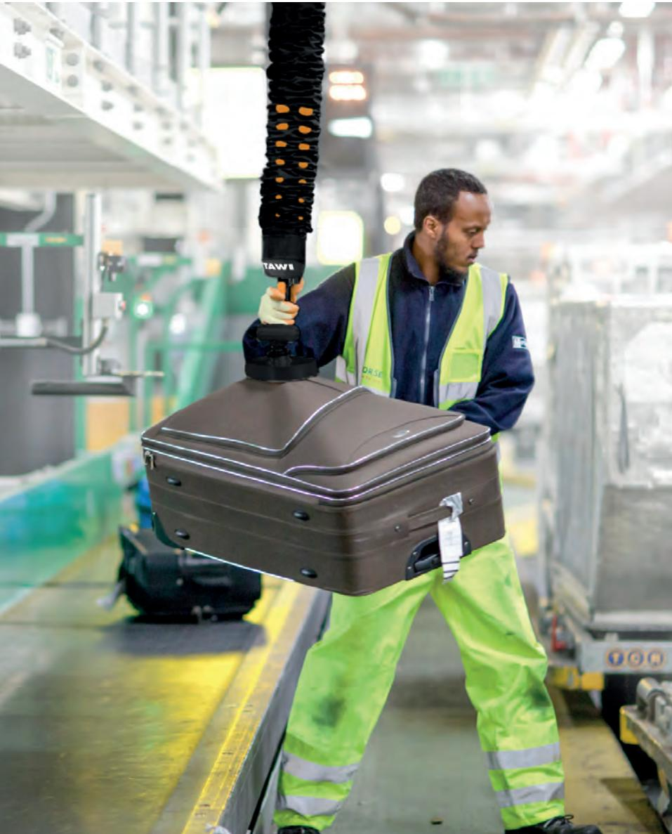
La movimentazione di bagagli pesanti è facile e senza sforzo con il nostro sollevatore a vuoto ad alta frequenza. Il bagaglio può essere ruotato di 360 gradi prima di essere posizionato e l'adattatore angolare permette all'operatore di ruotare la ventosa di 90 gradi per sollevare i bagagli lateralmente.
