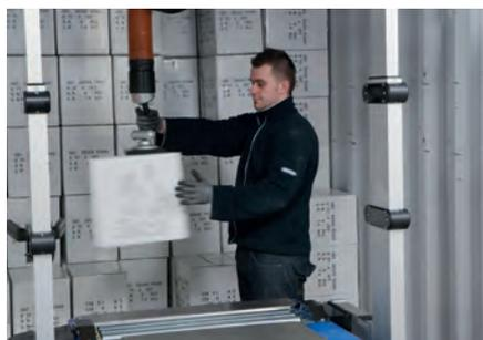
Progettato per risolvere problemi di ergonomia e produttività durante il carico o lo scarico di rimorchi o container. Può essere completamente integrato con trasportatori telescopici.
