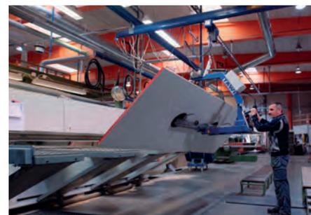
Il gripper per lastre è ideale per la movimentazione di pannelli di legno. Grazie alla funzione di inclinazione, potrai inclinare agevolmente, fino a 180 gradi, carichi fino a 250 chili.
