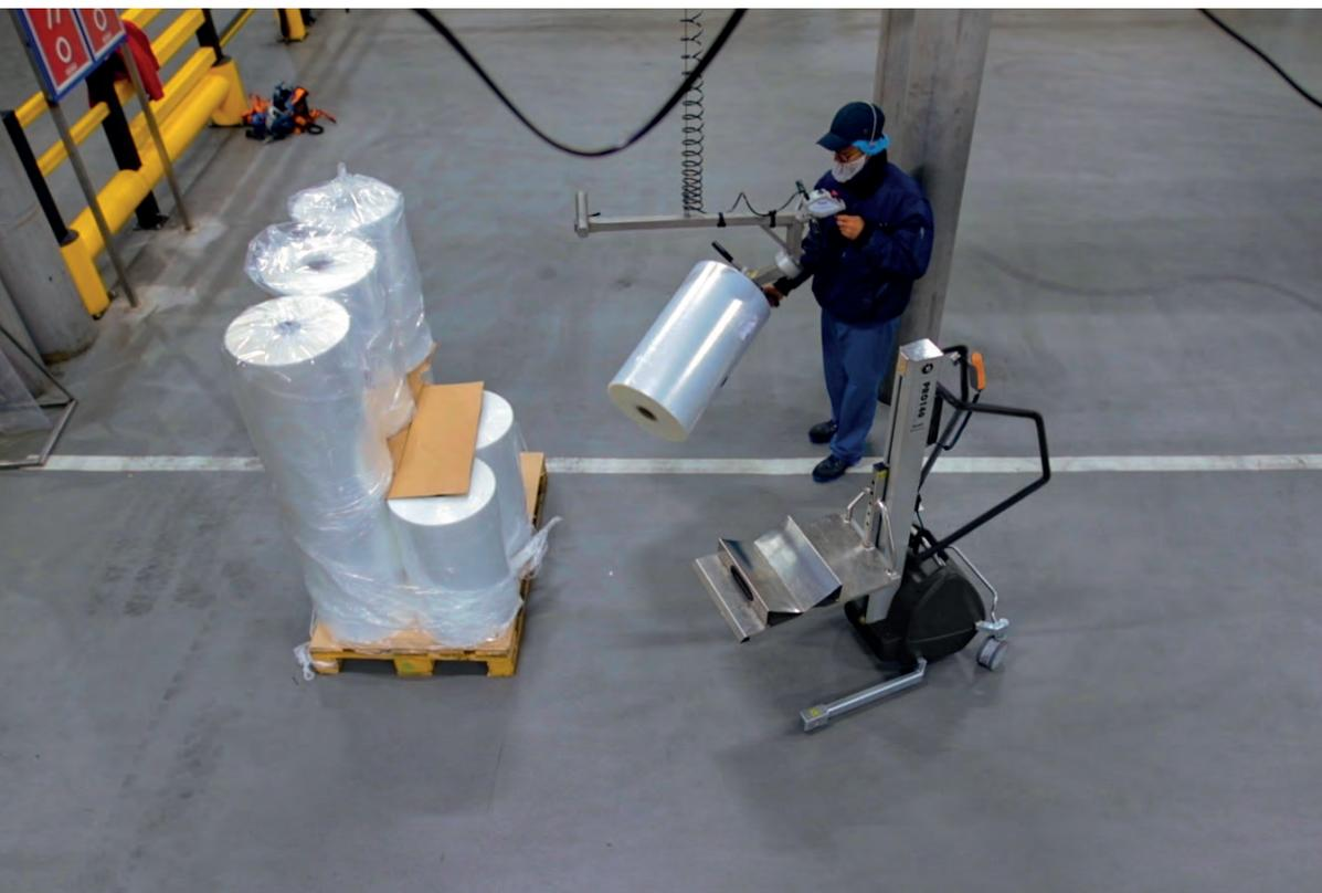
I sollevatori possono essere facilmente combinati con altre soluzioni di sollevamento TAWI. Nell'immagine di lato viene usato per sollevare pesanti rotoli di pellicola da un pallet, inclinarli e metterli su un carrello. Il carrello viene poi utilizzato per trasportare e montare i rotoli nelle macchine confezionatrici.
