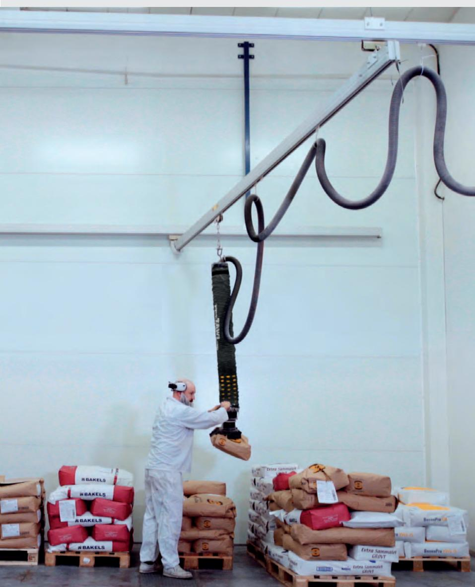
I carrelli su cuscinetti scorrono senza intoppi lungo i profili, permettendo di spostare facilmente il carico esattamente dove ti serve.
