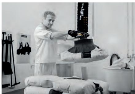
I sollevatori a vuoto garantiscono una movimentazione sostenibile, sicura ed efficiente per la maggior parte delle tipologie di merci fino a 270 kg.
