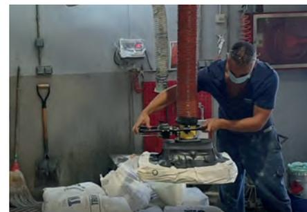
Hempel ha investito in sistemi TAWI classificati ATEX per la movimentazione di fusti di vernice e in sollevatori a vuoto per velocizzare la movimentazione dei sacchi tra i pallet.
