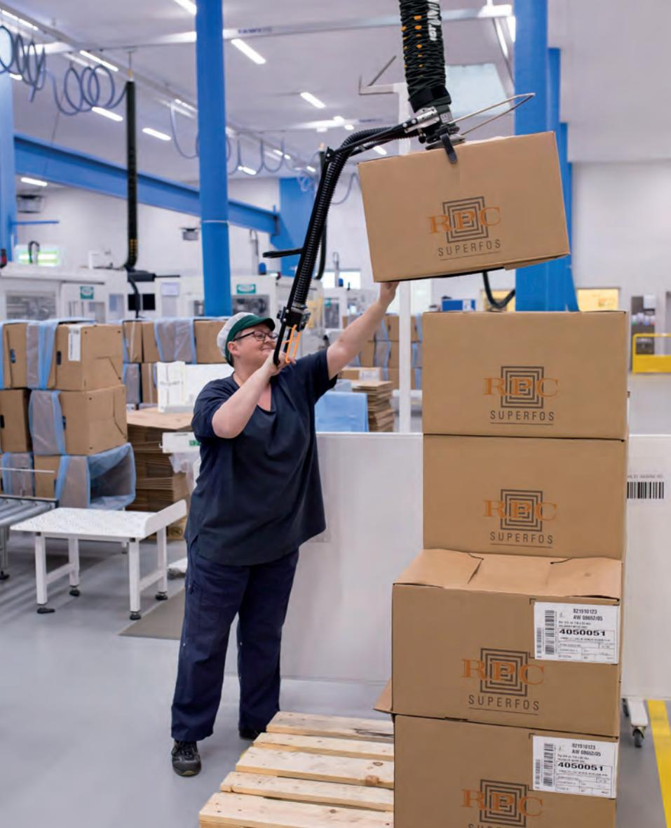
Con il nostro sollevatore a vuoto, sollevare al di sopra dell'altezza delle spalle sarà facile e privo di sforzo.
