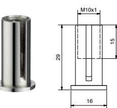
**Deckenbefestigung mit Schlitz DSH 260**,
