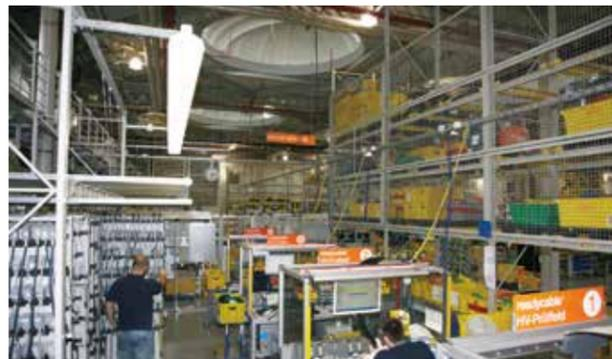
Rechnergestützte Hochspannungsprüfung und Endkontrolle aller konfektionierte Leitungen
