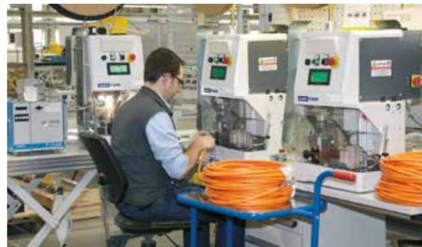
Moderner Maschinenpark: automatische Stripper-Crimper
