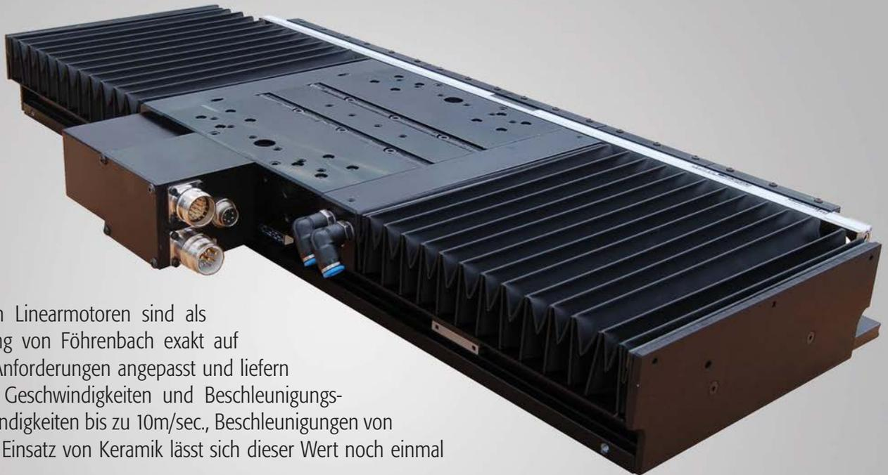
Die integrierten Linearmotoren sind als Eigenentwicklung von Föhrenbach exakt auf die jeweiligen Anforderungen angepasst und liefern konstant hohe Geschwindigkeiten und Beschleunigungswerte (Geschwindigkeiten bis zu 10m/sec., Beschleunigungen von bis zu 3 G, bei Einsatz von Keramik lässt sich dieser Wert noch einmal verdoppeln).
