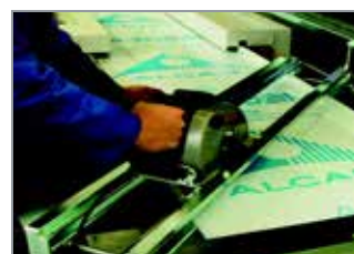
Querteilanlage mit beidseitiger Schrägtrennung bis 45°
