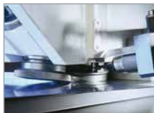
Umformrollen für die automatische Blechführung mit Bordhöhe 10 mm
