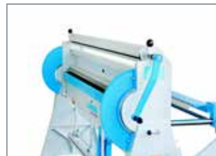
Stahlwalzen zum Rinnen runden von diversen Durchmessern.
