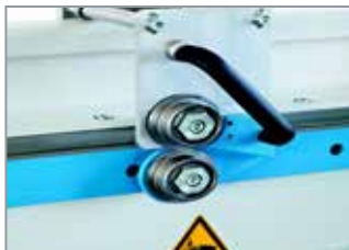
Rollenschere für Stahl-Blechdicken bis 0.8mm.
