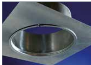
Schnell und einfach mit den Schraubsickenwalzen erstellt.
