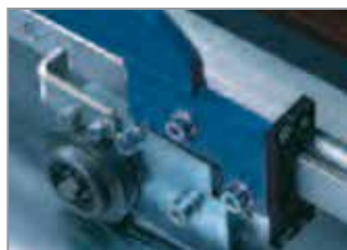
Rollenschere zum Quertrennen von Hand vor dem Profilieren.
