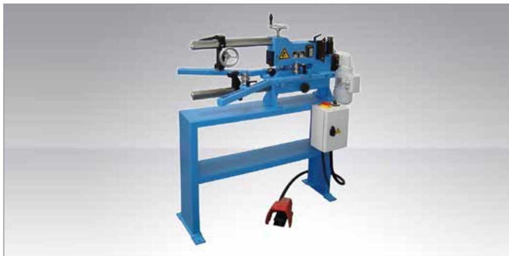
Beispielbild in Sonderausrüstung mit Bördeleinrichtung für Innen- und Aussenbord
