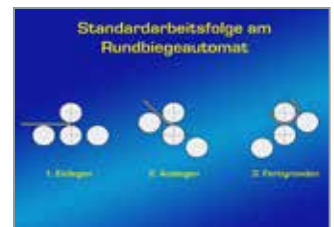
Diese Arbeitsweise ermöglicht eine sehr gute Anbiegung
