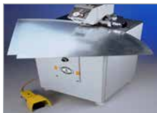
Der Fußschalter erleichtert das Ein- und Ausschalten der Maschine bei großen Blechen.
