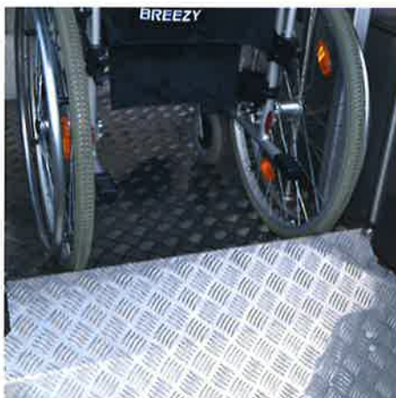
Zugleich Abrollsicherung und Auffahr- rampe für den Rollstuhlfahrer
