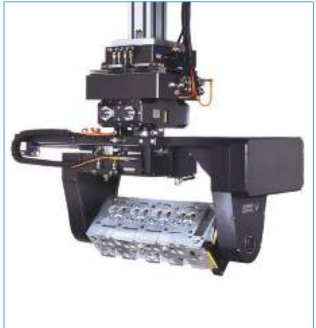
▶ Manipulador de cabezales cilíndricos
