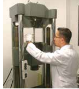
Çekme Testi / Tensile Test TS EN ISO 6892-1 / TS EN ISO 4136 ASTM E8 / ASTM A370
