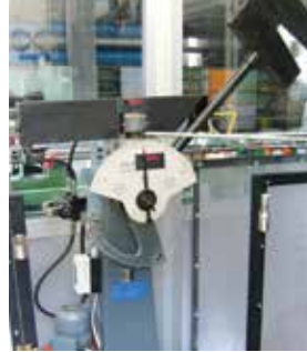
Darbe Testi / Impact Test TS EN ISO 148-1 ASTM A370 / ASTM E23 / TS EN ISO 9016
