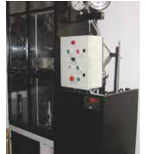
Hidrostatik Test / Hydrostatic Test TS EN ISO 10246 - 2
