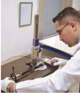
Yüzey Pürüzlülük Testi / Surface Roughness Test TS EN ISO 971 / TS EN 10049 ASTM A7127 / TS EN ISO - 971
