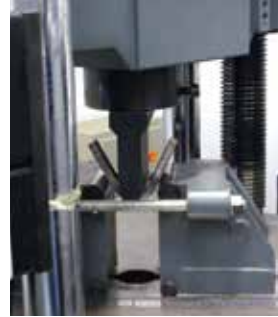
Eğme Testi / Bending Test TS EN ISO 5173 / ASTM E190
