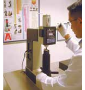
Sertlik Testi / Hardness Test TS EN ISO 6506-1 / TS EN ISO 6507-1 TS EN ISO 6508-1 / TS EN ISO 9015-1 ASTM E10 / ASTM E92 / ASTM E18 / ASME Sec.IX
