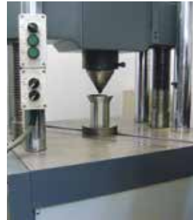
Ağız Genişletme Testi / Flaring Test TS EN ISO 8493 / ASTM A370
