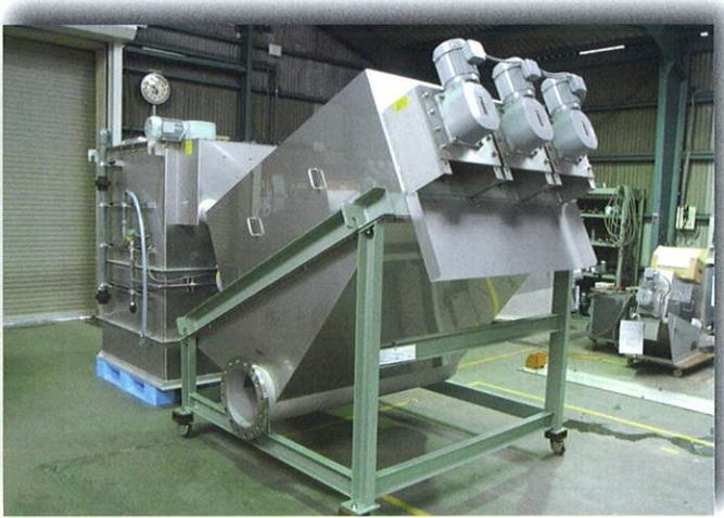
Le sécheur de boue à volute peut sécher des boues provenant de bassins d'aération ou de bassins d'épaississement. Il prend une part active dans beaucoup d'usines de traitement à grande échelle.
