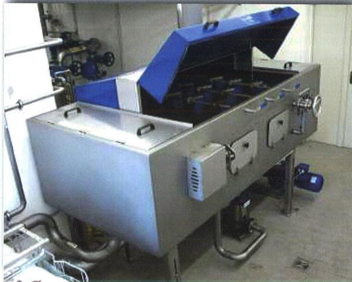
Le **MINIDRAIN HMS MD** fonctionne sur le principe de filtration de gravité et, en dépit de son encombrement réduit, offre des performances élevées.
