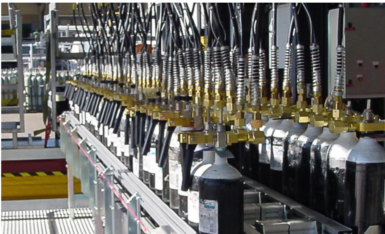
WEH® TW42 für Anwendungen mit medizinischem Sauerstoff und Pin-Index Anschluss
