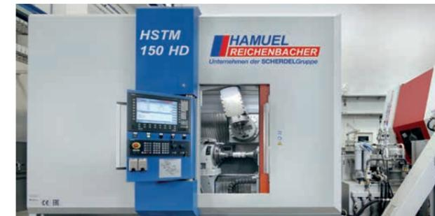
HSTM 150 HD: CNC-Fräslösungen für die 5-Achs-Bearbeitung.
