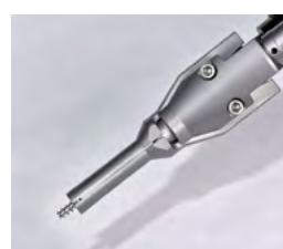
**CON PORTE FRIZIONATE** che trattengono la vite sulla testa e non sul gambo: non apprendersi permettono alla testa di inserirsi senza occupare ulteriori ingombri anche all'interno di fori e con punti di avvitatura profondi
