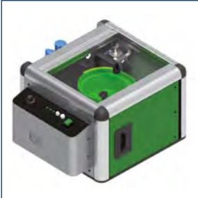
Alimenta due slitte a singolo o doppio movimento, equipaggiate con motore per avvitare pneumatico. Il ciclo di lavoro prevede la selezione e lo sparo di 2 viti contemporaneamente. Per viti con lunghezza compresa tra 35 e 60 mm.
