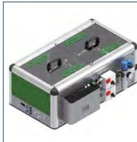
Con la sua doppia tazza circolare è in grado di processare 2 viti con geometrie simili, ad esempio con lunghezza diversa o materiale diverso (es. inox / acciaio brunito) ed alimentare una slitta (una via). La scelta della vite viene gestita dal PLC dell'alimentatore attraverso un selettori oppure da un segnale esterno. Per viti con lunghezza compresa tra 10 e 35 mm.
