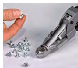
**ANTIRIBALTAMENTO VITE** quando si hanno viti con rapporto lunghezza vite/diametro testa, inferiore a 1,5.
