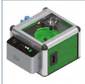
Utilizzato quando è necessario impiegare motori per avvitare con elevati consumi e che comportano l'impiego di Gruppi FRL maggiorati. Per viti con lunghezza compresa tra 10 e 35 mm.
