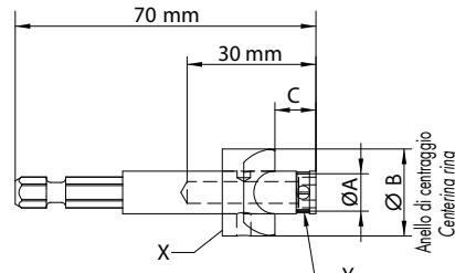
Quota C: Misura minima utile affinché l'anello di centraggio ( $\varnothing$  B) durante l'avvitatura non entri in contatto con i componenti da assemblare. Su richiesta chiavi personalizzate.
