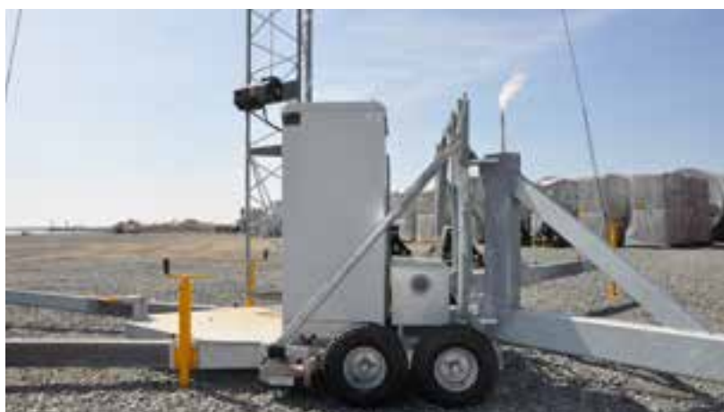
Selvående enhed med 15 meter teleskopmast.
