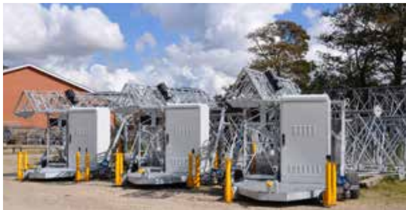
Ovenstående teleskopmaster er mobile enheder til overvågning af områder for at forebygge tyveri og hærværk. Enhederne er selvkørende over kortere afstande.
