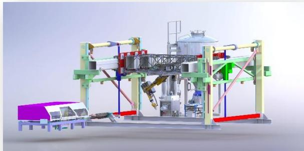
Der Drucker benötigt nur einen festen, ebenen Untergrund (Fundament) auf dem er stationär aufgebaut werden kann.
