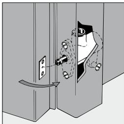
Stecken Sie die Kolbenstange vom Fahrstuhlschacht aus durch ein ca. 15 bis 20 mm großes Loch der Türzarge und verschrauben den Dämpfer an drei Punkten mit der Zarge.
