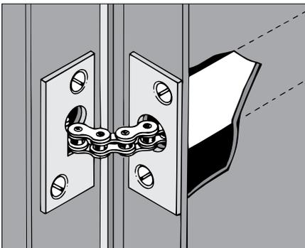
Bohren Sie zunächst stirnseitig in das Türblatt ein Loch  $\varnothing 23$  mm für die Aufnahme des Federrohres. Anschließend Einbauadjunkt in das Türblatt schieben und mit zwei Senkkopfschrauben befestigen. Danach ist die Gegenplatte an der Türzarge ebenfalls mit zwei Senkkopfschrauben zu befestigen - genau gegenüber der Frontplatte, insbesondere auf gleicher Höhe.
