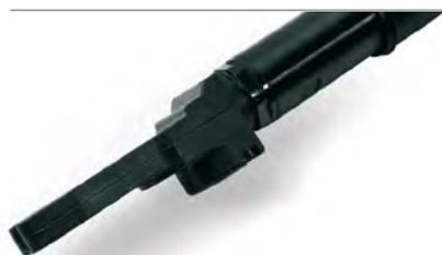
*La testa con ingranaggio cieco agevola l'avvicinamento del dado alla giunzione*
