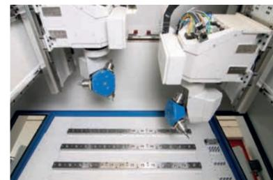
Kardanisch gelagerte Sternfräsköpfe (Aggregatevariante) der Schrägbettmaschine ECO-RS.
