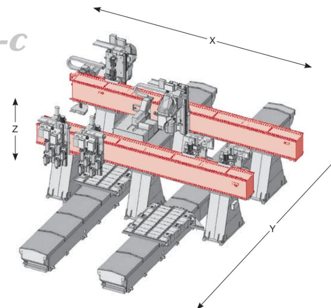
Der Maschinentyp **ECO-C** ist durch ein feststehendes, schwingungsarmes 3-Ständer-Portal mit zwei fahrbaren Bearbeitungstischen gekennzeichnet. Die Tische sind je zwischen dem linken und mittleren bzw. mittleren und rechten Portalständer angeordnet. Mit zwei Aggregaten ist, durch den großen Tischabstand, eine völlig unabhängige Bearbeitung auf den beiden Maschinenhälften möglich.
