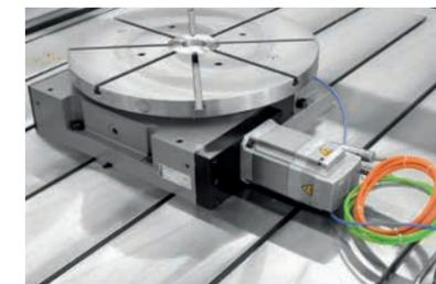
NC-Rundtisch für Präzisions-Drehfrästeile (zum Beispiel Flugzeugturbinenring).
