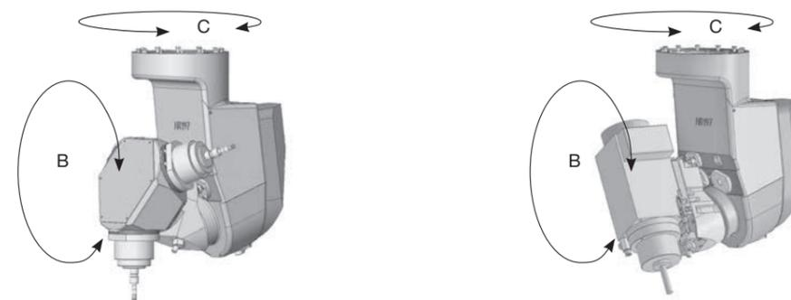
**5-Achs-Sternfräskopf** mit kardanisch gelagertem 3-fach Frässpindelrevolver. Die Spindeln sind sternförmig, im Winkel von 120° zueinander, angeordnet. Der Spindel- bzw. Werkzeugwechsel erfolgt durch die Weitertaktung des Spindelrevolvers. Die Arretierung erfolgt über eine mechanische Verriegelung.
