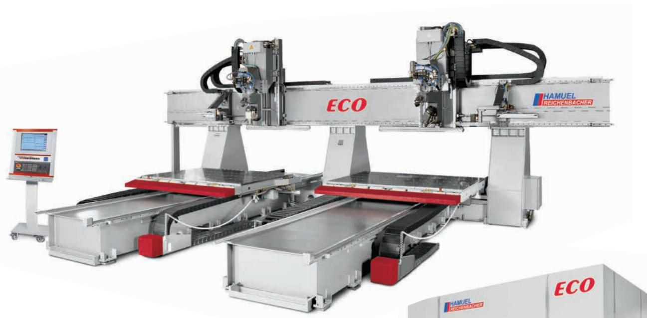
Ein Koordinatentisch, ein programmierbarer Trägertisch mit schnellrüstbaren Spannvorrichtungen, oder ein selbstrüstender Pintisch, ermöglichen es, die Produktion auftragsbezogener Werkstücke der Losgröße 1 mit den Anforderungen an eine serielle Fertigung zu verwirklichen. Die ECO ist keine Maschine von der Stange. Ihre Anregungen und Wünsche fließen in die Planung und in das sorgfältig erarbeitete Angebot ein.
