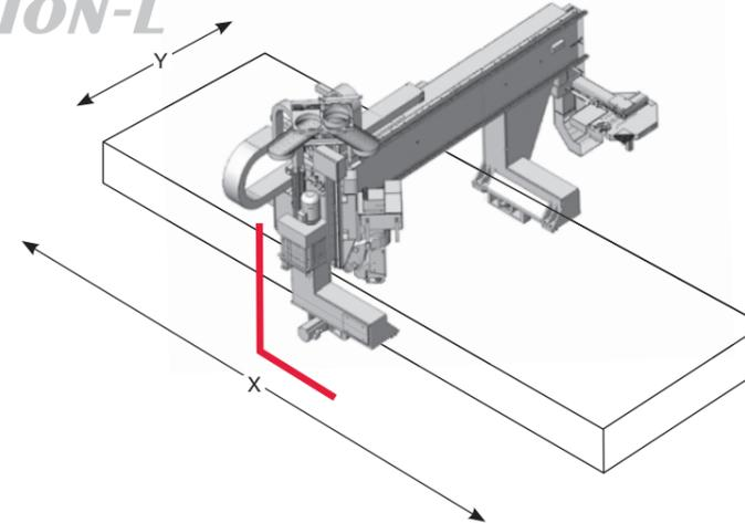
Bei der **VISION-L** können bis zu zwei voneinander unabhängige Y-Schlitten zur Aufnahme der Aggregate hintereinander verbaut werden. Damit ist ein hauptzeitparalleler Werkzeugwechsel aus zwei Werkzeugmagazinen sowie die Synchronbearbeitung von zwei hintereinander liegenden Werkstücken – zum Beispiel beim Einsatz von 5-Achs-Gabelarbeitsköpfen – möglich. Die voneinander unabhängigen Aggregate, angebracht auf einem L-Träger in Y-Richtung, garantieren eine hohe Verfügbarkeit.
