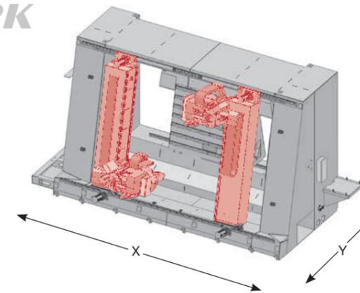
In den Bearbeitungszentren vom Typ **ECO-RS-2K** sind zwei Arbeitsaggregate installiert. Somit können zwei kleine Bauteile gleichzeitig oder ein Bauteil gemeinsam bearbeitet werden. Arbeitsaggregat 1 und Arbeitsaggregat 2 sind jeweils auf unabhängigen Aggregatträgern angebracht. Durch hauptzeitparallelen Werkzeugwechsel kann während des Fräsens bereits das nächste Werkzeug eingewechselt werden.
