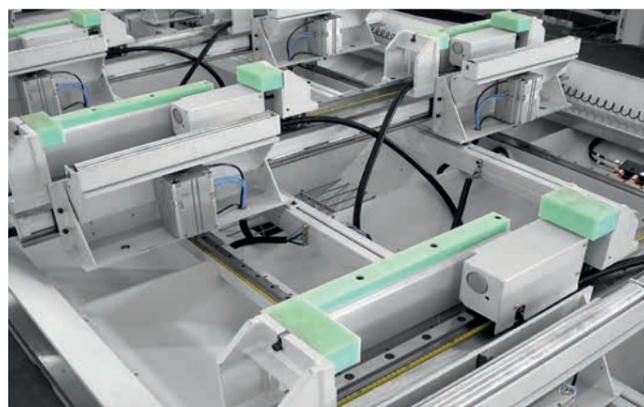
Pneumatischer Horizontalspanner in schwerer Ausführung mit Unterstützungsrollen.
