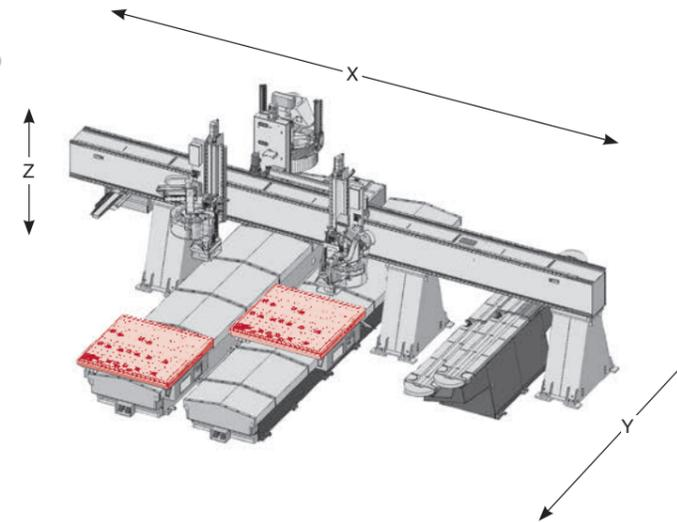
Der Maschinentyp **ECO-B** ist durch ein feststehendes, schwingungsarmes 2-Ständer-Portal mit zwei fahrbaren Bearbeitungstischen gekennzeichnet. Die Tische sind direkt nebeneinander angeordnet; somit kann für die Bearbeitung von großen Bauteilen eine Tischkopplung erfolgen.
