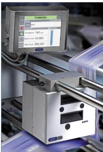
Cabezales de impresión por transferencia térmica de Linx ideales para embalaje flexible.
