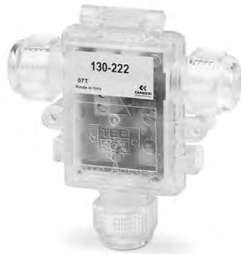
Dieses Steuergerät Serie 130 eignet sich für alle Proportionalventile bis max. 1 A. Ein Standard-Eingangssignal von 0-10 V oder 4-20 mA wird proportional in ein PWM-Ausgangssignal umgewandelt.
