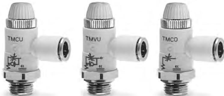
Die Drossel-, Drosselrückschlagventile der Serie TMCU, TMVU und TMCU wurden entwickelt, um eine Lösung anzubieten, die bei reduzierten Bau-massnahmen sehr gute Durchfluss-eigenschaften aufweist. Ihre kompakte Konstruktion erlaubt eine einfache Montage an Zylindern und Ventilen und bietet die Möglichkeit die vorgenommene Durchflusseinstellung über eine Kontermutter zu sichern.
