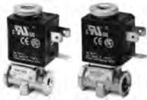
Bei Version NC und NO IN-LINE sind Druckanschluss, Verbraucheranschluss und Entlüftung gleich positioniert. Bei der NO Version befindet sich der M5 Druckanschluss 1 an der Oberseite der Spule.
