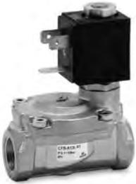
Bei den vorgesteuerten Membranventilen wird die Membrane durch eine Druckdifferenz betätigt. Sie eignen sich bei hohen Durchflüssen und relativ geringen Medien-Drücken.
