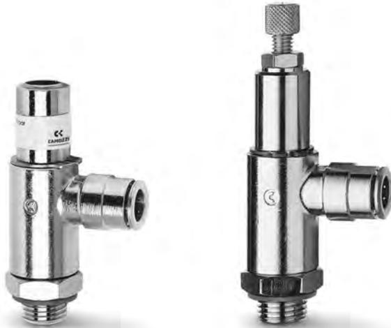
Diese Drossel-, Drosselrückschlagventile werden im Zylinder bzw. Ventil montiert. Es ist darauf zu achten, dass jeweils die abströmende Druckluft geregelt wird.
