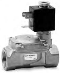
Bei den vorgesteuerten Membranventilen wird die Membrane durch eine Druckdifferenz betätigt. Sie eignen sich bei hohen Durchflüssen und relativ geringen Medien-Drücken.
