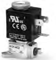
Ideal zur direkten Batteriemontage mit Hilfe von 2 Schrauben. Die Abdichtung erfolgt über 2 O-Ringe, die eine 360°-Drehung ermöglichen. Ausgestattet mit einer bistabilen Handhilfsbetätigung.
