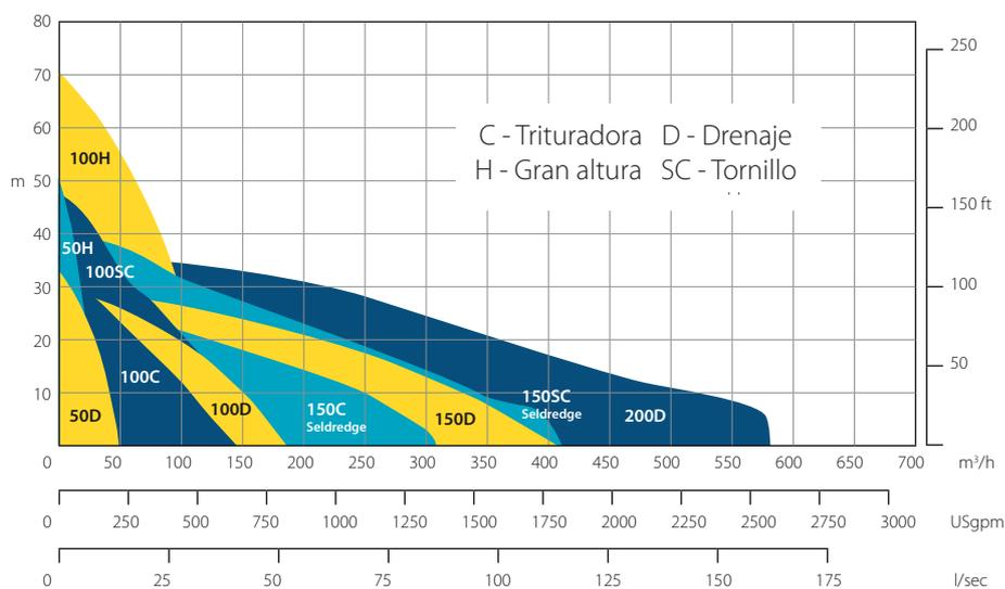
Las curvas que se muestran se corresponden únicamente con motores diésel. Las curvas de los motores eléctricos pueden ser diferentes. Consulte la hoja de datos correspondiente de la bomba específica.
