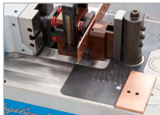
Stanzwerkzeug für Löcher bis Ø 30 mm. Max. Materialstärke 5 mm.
