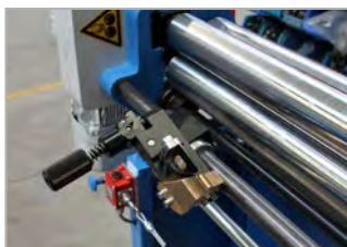
Spezieller Seitenanschlag zum Konischrunden (Option).
