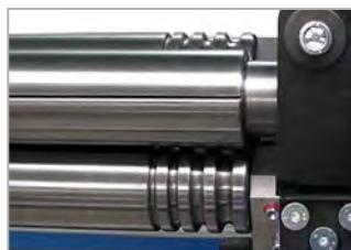
Falznute und Drahteinlegerillen (Option).
