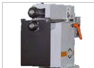
Geteilter Anschlag mit gehärteter grosser Anschlagplatte (240 x 160 mm).
