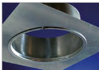
Schnell und einfach mit den Schraubsickenwalzen erstellt.
