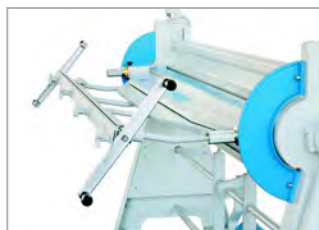
Wulsteinrichtung für diverse Durchmesser.
