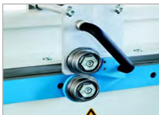
Rollenschere für Stahl-Blechdicken bis 0.8 mm.
