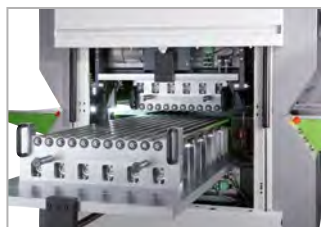
Beispiel einer elektromotorischen Reinigungs- und Schnellwechseleinrichtung
