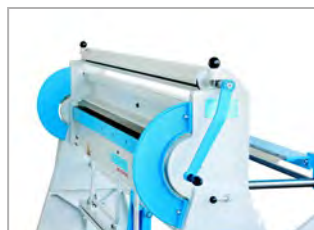
Stahlwalzen zum Rinnen runden von diversen Durchmessern.
