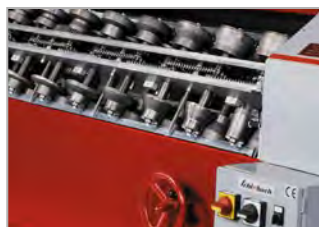
Einfaches, schnelles und flexibles Wechseln der Profilierungskassetten.
