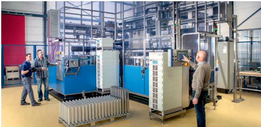
Vollautomatische Anlage zur selektiven Hartverchromung (SELGA-COAT® CHROM)
