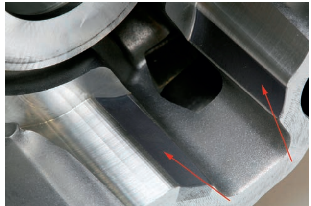
Aluminium-Bauteil mit Flächen, die im LASOX-COAT®-Verfahren beschichtet wurden
