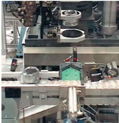
Automatische Anlage zur selektiven Hartanodisation der ersten Ringnut von Motorkolben; die Arbeitsvorgänge sind Anodisieren, Spülen und Trocknen; die Taktzeit der Anlage beträgt 12,5 s pro Kolben.
