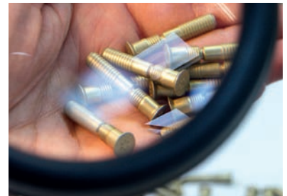
Befestigungselemente mit einer IVD-Aluminiumbeschichtung
