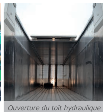
Ouverture du toit hydraulique
