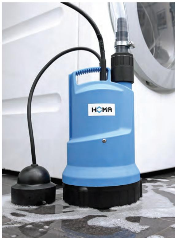
C240 WF: Automatische Einschaltung ab einem Wasserstand von 5 mm - Restabsaugung bis auf 2 mm.
