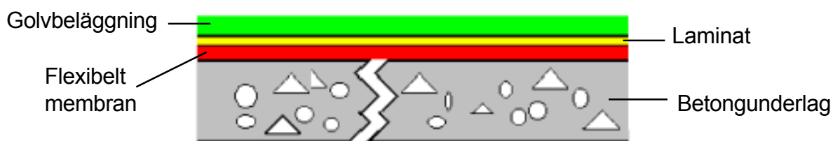
Uppbyggnad av spricköverbryggande beläggning
