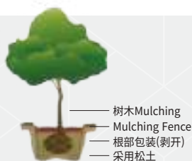
1. Mulching处理施工断面
