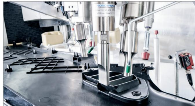
Kundenspezifisch auf die Anwendung angepasste Werkräume für das Verbinden von Kunststoffteilen mittels Ultraschall
