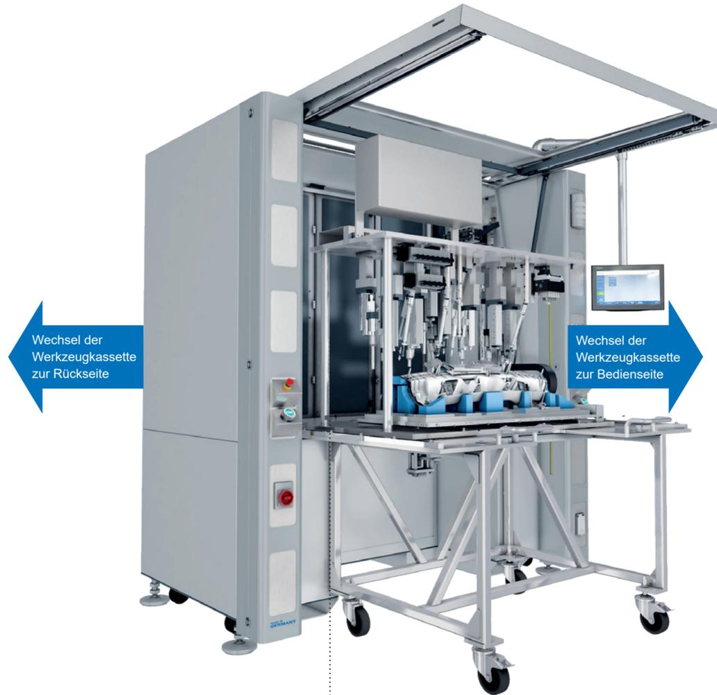
Schneller Wechsel der Werkzeuge durch Gestaltung des Werkraumes als Werkzeugkassette mit Hilfe nach vorne und hinten möglich
