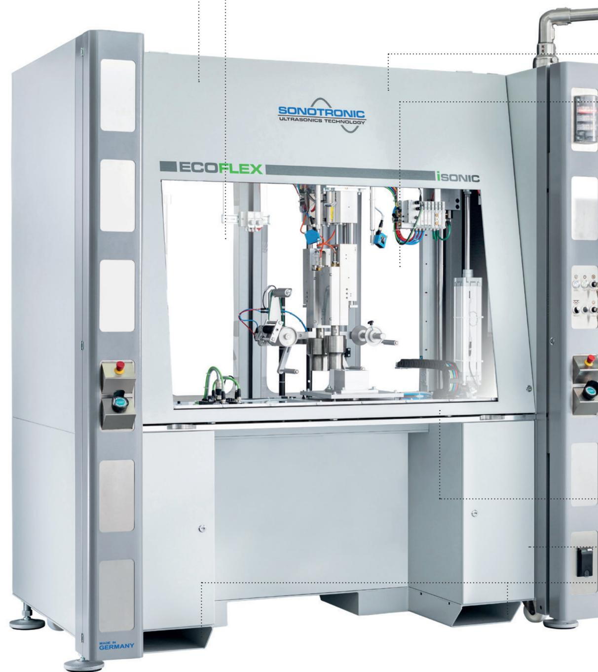
Front zu Wartungszwecken und zum Werkzeugwechsel komplett um 90° nach oben klappbar
