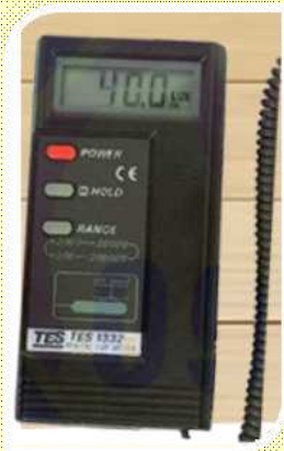
교체전 MH400W : 400 lx => 교체후 LED100W+LED200W : 754 lx (Relux 프로그램 예상조도값 652lx)
