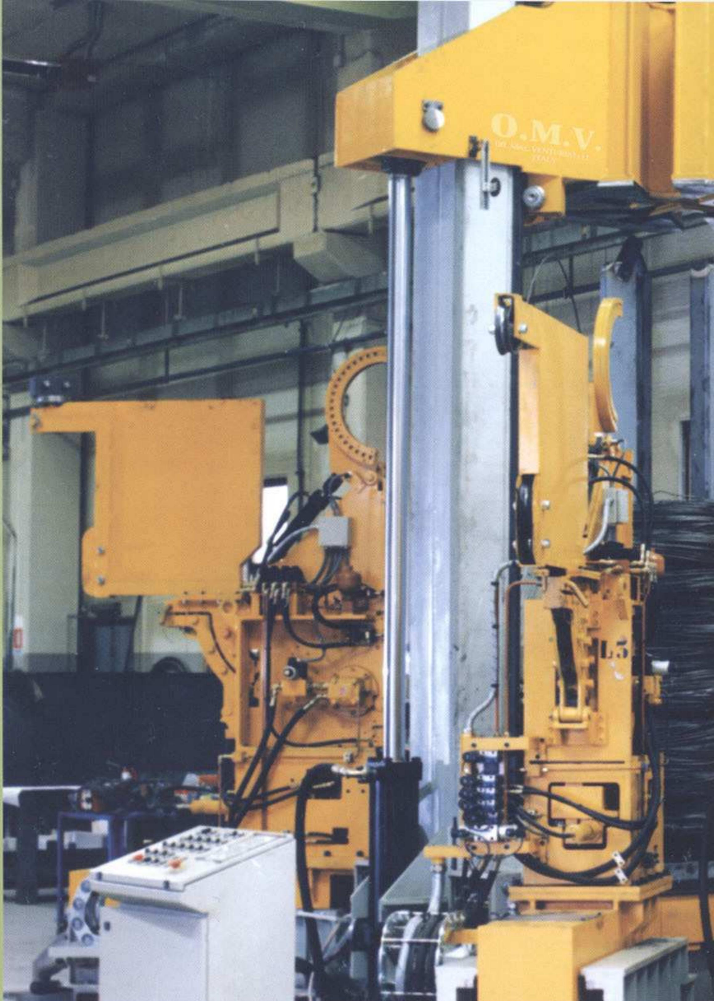
Questa macchina è adatta alla confezionatura di matasse di medie e grandi dimensioni (con altezze fino a 3 - 3,5 mt) che vengono prima pressate per minimizzarne l'ingombro e successivamente legate attraverso un nodo ad alta resistenza posizionato parallelamente all'asse della matassa e di forma piatta. Le matasse in questo caso devono essere trasportate verticalmente con un sistema a pallet, trascinati da rulli motorizzati.
