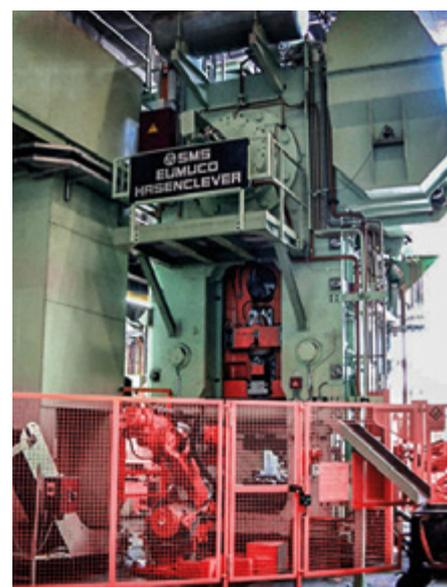
Direktisolierung einer 4.400 kN schweren EUMUCO Schmiedepresse mit isoloc Pressenlagerungssystemen HPD500. Die Übertragung stoßartiger, transientser und periodischer Störkräfte konnte wesentlich vermindert werden.
