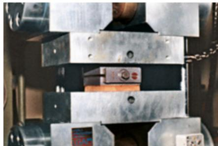
Messen der Verstellmomente beim Nivellieren der isoloc UMS Universal-Präzisions-Maschinenschuhe bei unterschiedlichen Belastungen. Ebenso wird die maximale Belastung bis zum Bruch ermittelt (LGA Nürnberg).
