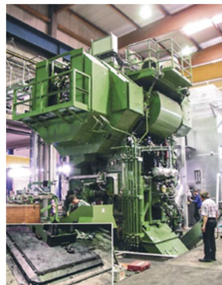
EUMUCO-Schmiedepresse auf isoloc Pressenlagerungssystemen mit komplettem Medienschutz.
