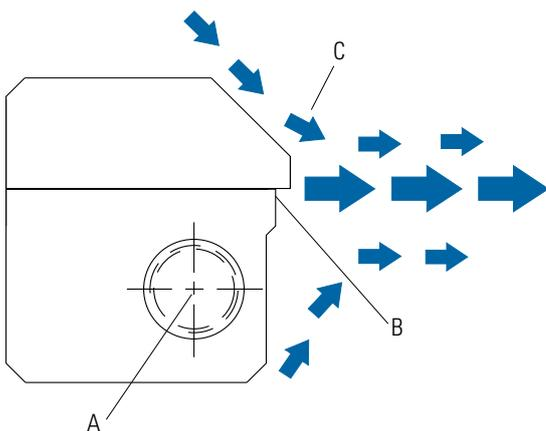
Konstanter Hochgeschwindigkeitsluftstrahl für schnelles Trocknen und Abblasen. Druckluft fließt durch einen Einlass (A) in die Austrittsöffnung. Der Primärluftstrom fließt durch die schlitzförmige Austrittsöffnung (B) und formt einen klingenartigen Blasstrahl. Kraftverstärkend wirkt die Sekundärluft, die von den Kanten des Blasbalkens mitgerissen wird (C). Als Resultat entsteht ein besonders gleichförmiger, harter Luftstrahl mit hoher Blaskraft.
