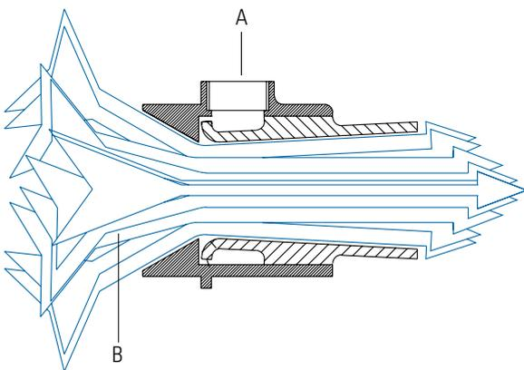
Der WindJet Luftverstärker intensiviert den Luftstrahl durch Erzeugung eines konstanten Luftstromes hoher Geschwindigkeit für zielgenaue Trocken- und Abblasvorgänge. Zusammen mit der Druckluft (A) wird angesaugte Umgebungsluft (B) durch die Einheit gesogen und erzeugt so eine maximale Luftverstärkung.
