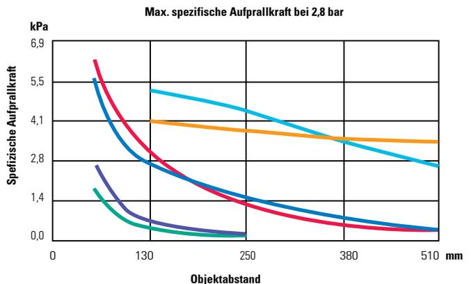
Die maximale spezifische Strahlkraft ist ein direktes Maß für die Strahlintensität, die auf eine Oberfläche aufschlägt. Sie gibt dabei die Höchstkraft pro Flächeneinheit an; sie kann zum Vergleich der Strahlleistung unter verschiedenen Bedingungen herangezogen werden.
