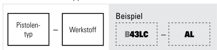
Hinweise: Duse fur Typ 31 + 43 goren nicht zum Lieferumfang und mussen separat bestellt werden. Standard: NPT-Gewinde. Bitte „B“ vor Typenbezeichnung setzen, wenn BSPT-Gewinde gewunscht.
