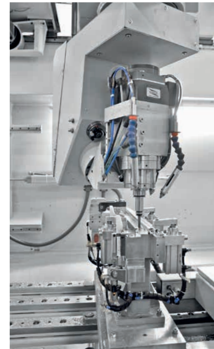
Kardanisch gelagertes 5-Achs-Arbeitsaggregat für effiziente 6-Seiten-Komplettbearbeitung an Formteilen und Profilen.
