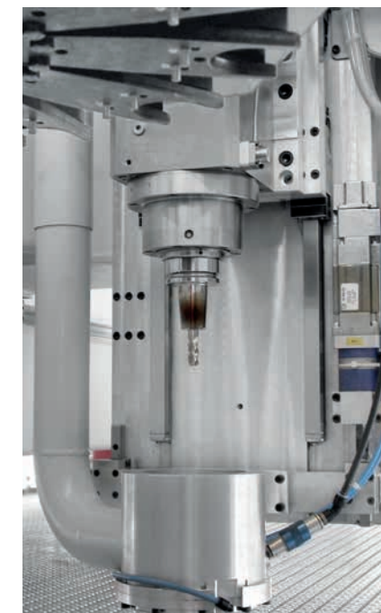
NC-höhenverstellbare Absaugglocke einer VISION zum Ausgleich der Fräserlängen. Die Spindel ist mit einer Kühlmitteldrehdurchführung ausgestattet.
