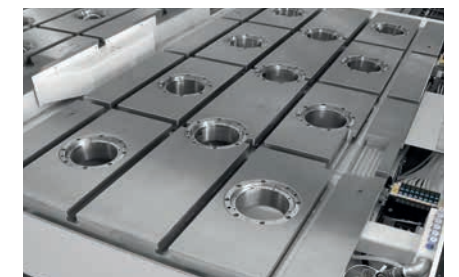
Koordinatentisch einer ECO, speziell für die hohen Anforderungen der Flugzeugindustrie.
