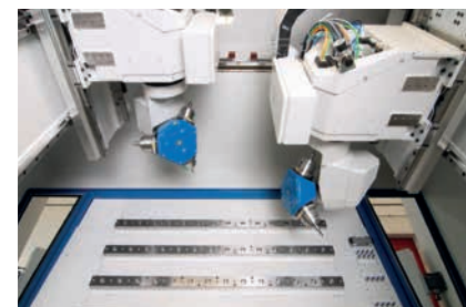
Kardanisch gelagerte Sternfräsköpfe (Aggregatevariante) der Schrägbettmaschine ECO-RS.
