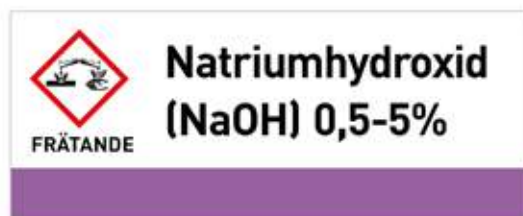
Cisternskylt med text, kemisk formel, färg och faropiktogram.
