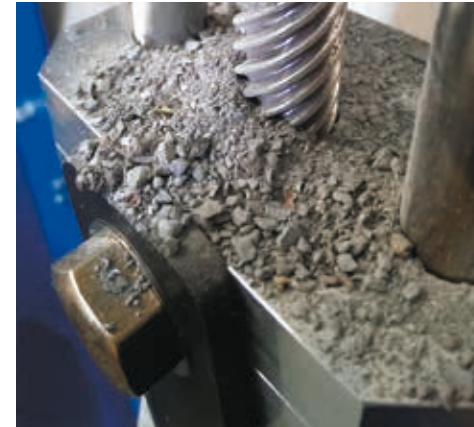
Test unter Extrembedingungen, z.B. bei Beaufschlagung mit unterschiedlichen Verschmutzungen
