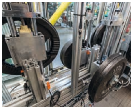
Prüfstand zur Lebensdauerermittlung
