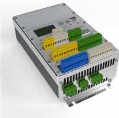
Die Montage der Steuerung ist sehr einfach, da sich das gesamte **Elektronikmodul auf einem Trägerblech herausnehmen** läßt. Auch der Deckel kann komplett abgenommen werden, da das Flachkabel zum Programmierdisplay nur abgesteckt werden muß. Dadurch kann das leere und damit leichte Gehäuse problemlos an der Wand befestigt werden. Die Elektronik kann nicht durch abrutschende Schraubenzieher oder ähnliches beschädigt werden.
