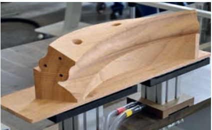
Interpolierende 5-Achs-Bearbeitung. Handlauf wird komplett bearbeitet und abgetrennt. Konstruktions- und Programmierung über Softwarehersteller.
