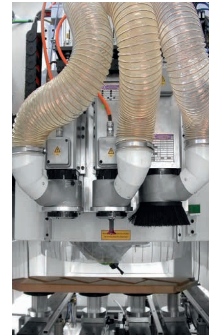
Arbeitsaggregate einer VISION-ST (Treppenfertigung), 5-Achs-Aggregat mit drei zusätzlichen Fräsmotoren.
