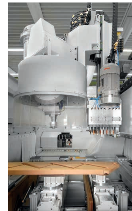
ARTIS-X mit automatischem Rüsttisch, 25-fach Mehrspindelbohraggregat und 36-fach Ketten-Werkzeugmagazin.
