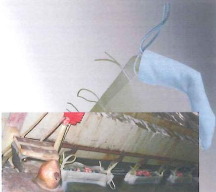
Filtertücher für Membran und Kammerfilterpressen.
