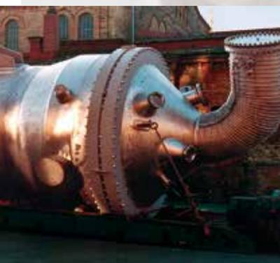
In der Regel werden Prozessgas-Kühler/Abhitzewärmeaustauscher mit direkt integriertem Reaktor für die Herstellung von Salpetersäure, Caprolactam oder auch Formaldehyd verwendet.
